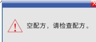
2□ 若配方数据错误, 例如: 某一物料目标量大于“0”, 且不符合目标量 $\geq$ 慢加量 $\geq$ 提前量的规则就报错。启动
